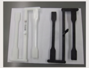
ISOダンベル試験片
